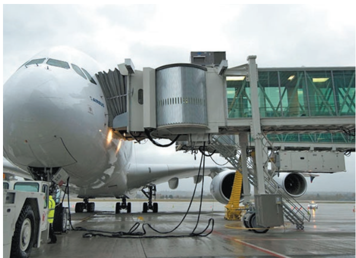
Puente de abordaje para pasajeros desplazable de plataforma para aeronaves FMC Jetway. © 2007 Foto de P. Michaud. Cortesía de FMC Technologies, Jetway.
